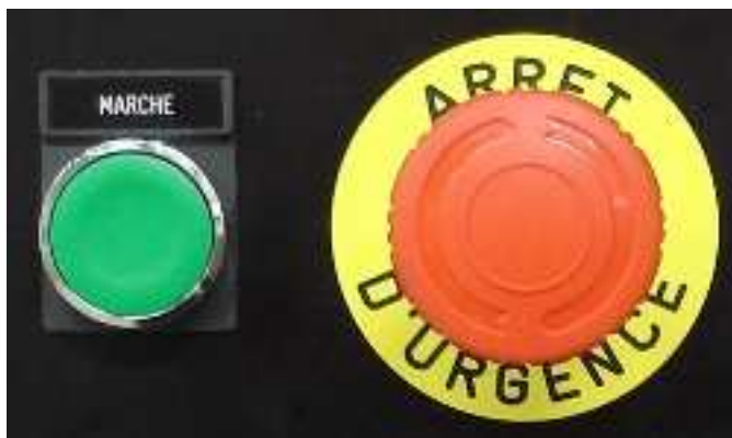
Boutons Marche et Arrêt urgence face avant en partie haute
